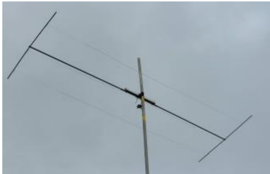
Het eindresultaat ziet er best uit als een antenne - een ringkern met enkele windingen RG58 dient als mantelstroomfilter.
